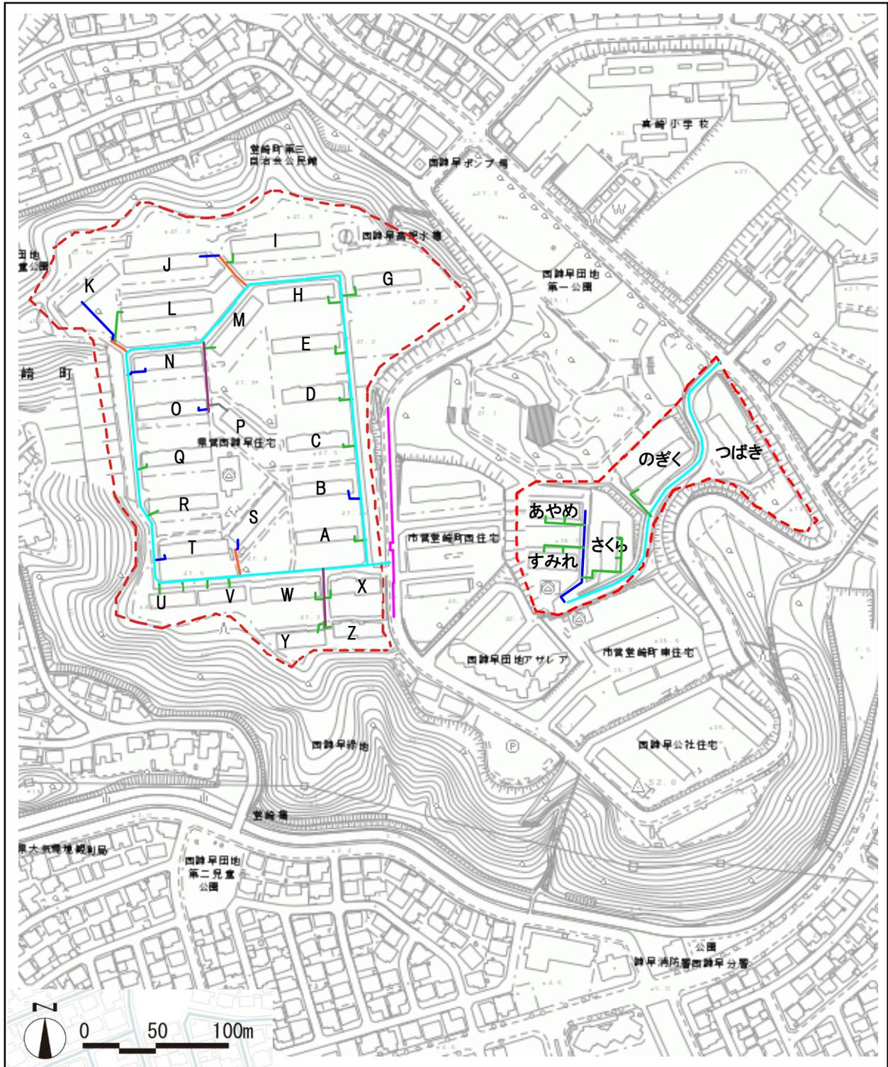
ガス配管図 (資料 九州ガス資料)
